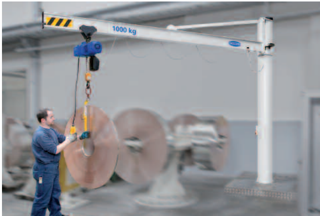
Säulenschwenkkrane mit Stahl-Kranschiene, 1000 kg Traglast, 5 m Auslegerlänge
