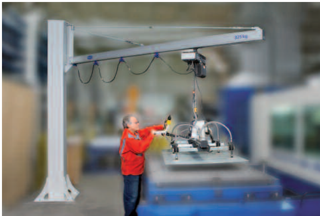
Säulenschwenkkrane mit Aluminium-Kranschiene, 325 kg Traglast, 4 m Auslegerlänge
