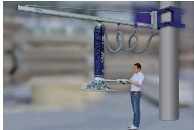
Wandschwenkkran mit Aluminium-Kranschiene an runder Betonsäule befestigt, 140 kg Traglast, 4,5 m Auslegerlänge
