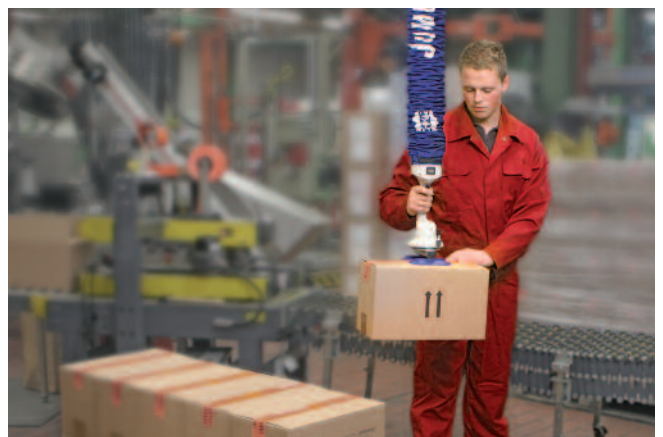
JumboFlex, Traglast 35 kg, mit Doppelsauggreifer zur Handhabung von Kartonagen
