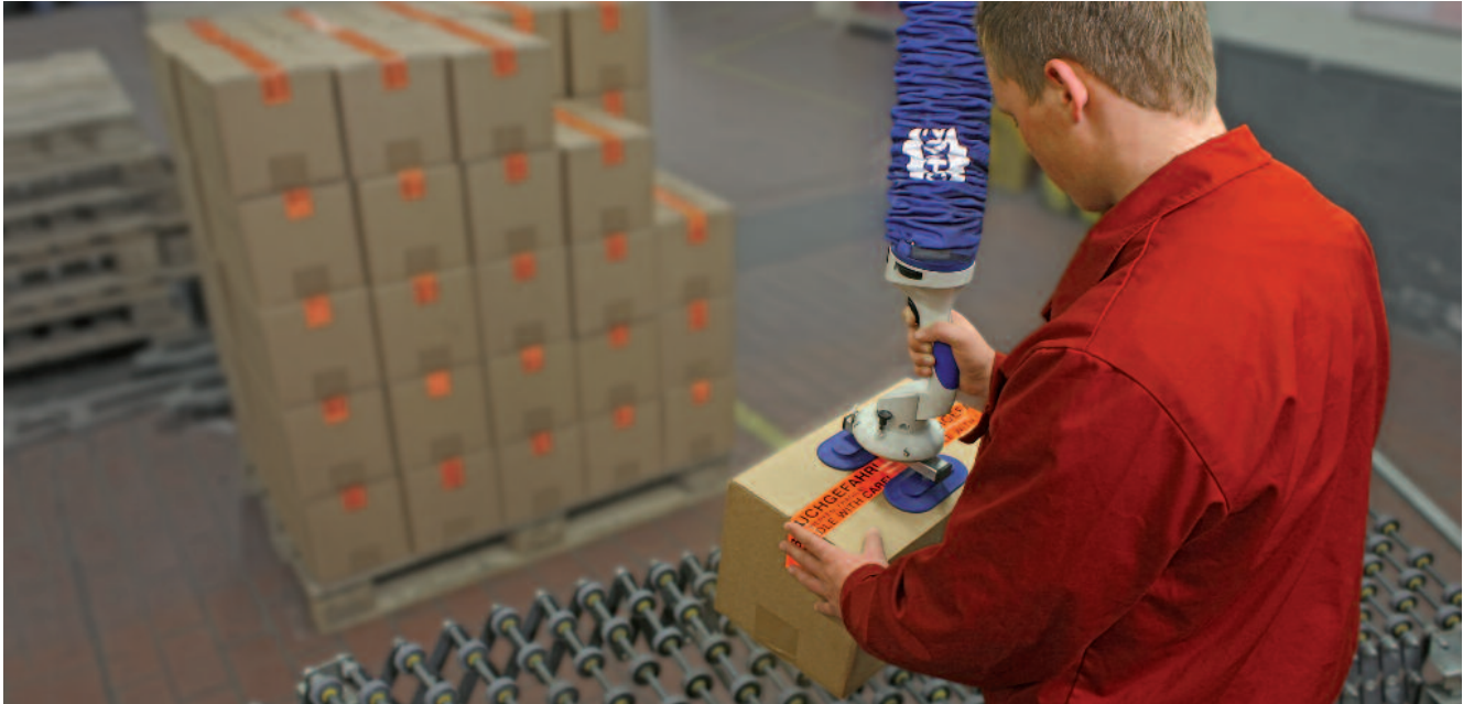
JumboFlex, Traglast 35 kg, mit Doppelsauggreifer zur Handhabung von Kartonagen
