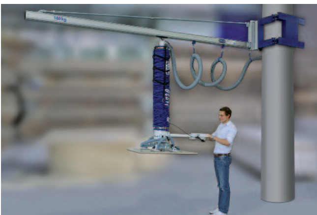
Wandschwenkkrane mit Aluminium-Kranschiene an Betonsäule befestigt, 140 kg Traglast, 4,5 m Auslegerlänge
