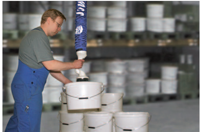
JumboFlex, Traglast 35 kg, mit Rundsauggreifer zur Handhabung von Eimern
