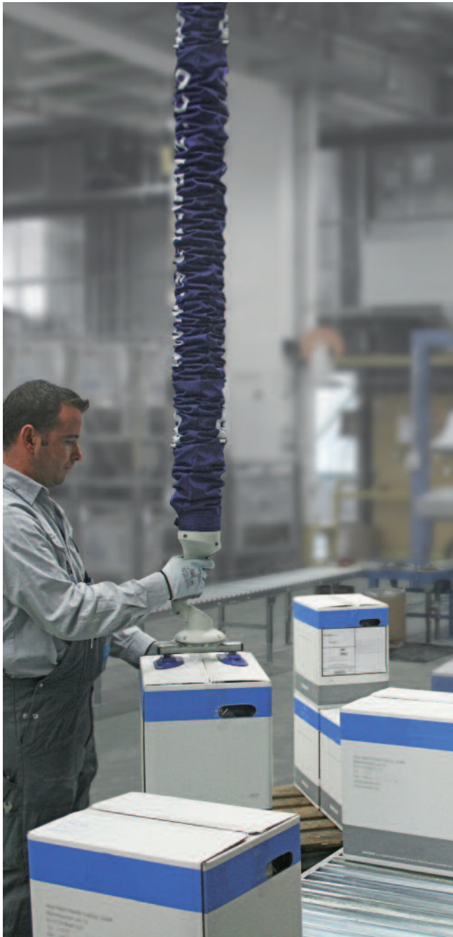
JumboFlex, Traglast 35 kg, mit Doppelsauggreifer zur Kartonhandhabung im Versandbereich
