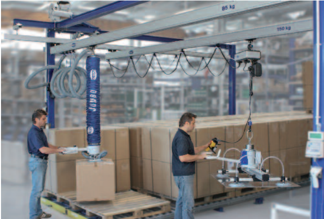
Aluminium-Einträger-Krananlage, 85 kg bzw. 150 kg Traglast, 2x6 m bzw. 4x6 m
