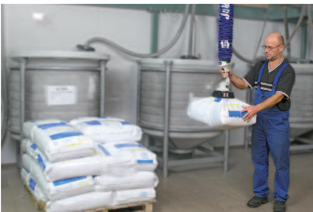
JumboFlex, Traglast 25 kg, mit Sacksauggreifer zur Handhabung von Säcken
