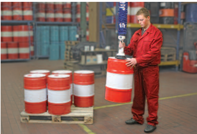
JumboFlex, Traglast 35 kg, mit Rundsauggreifer zur Handhabung von Fässern
