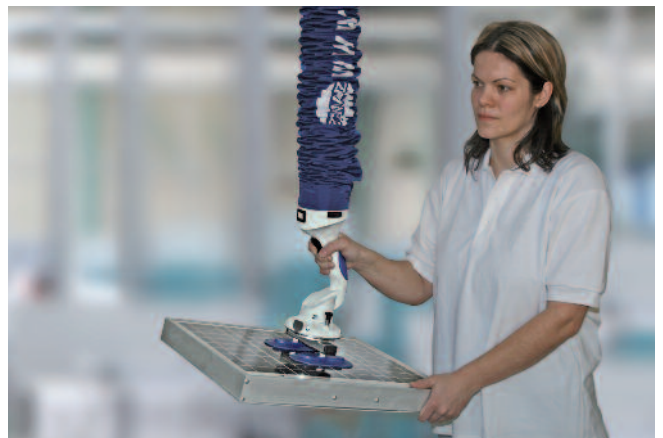
JumboFlex, Traglast 35 kg, mit Doppelsauggreifer zur Handhabung von Solarpanel
