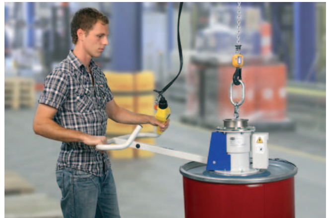
VacuMaster Eco, Traglast 250 kg, zur Fasshandhabung
