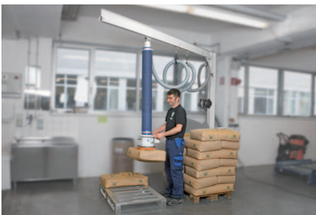
JumboSprint, Traglast 65 kg mit Sacksauggreifer, zur Kommissionierung von Kunststoff- und Papiersäcken
