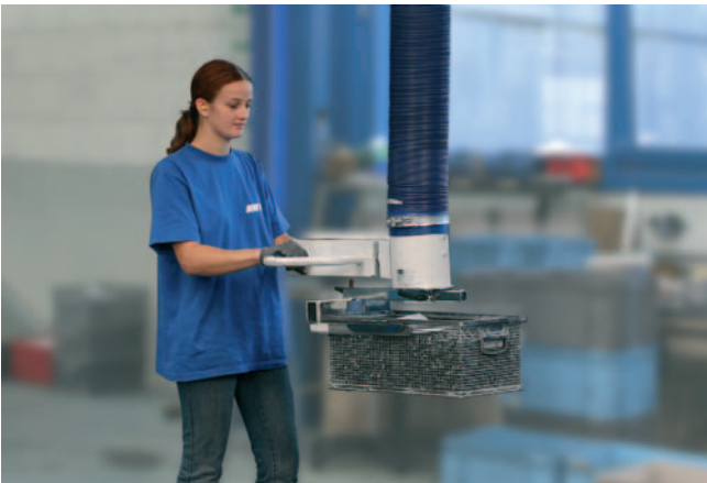
JumboErgo, Traglast 65 kg mit mechanischem Kistengreifer, zur Handhabung von Metallboxen
