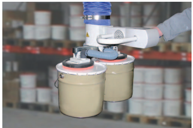
JumboErgo, Traglast 45 kg mit Doppelsauggreifer, zum gleichzeitigen Transportieren von zwei Eimern
