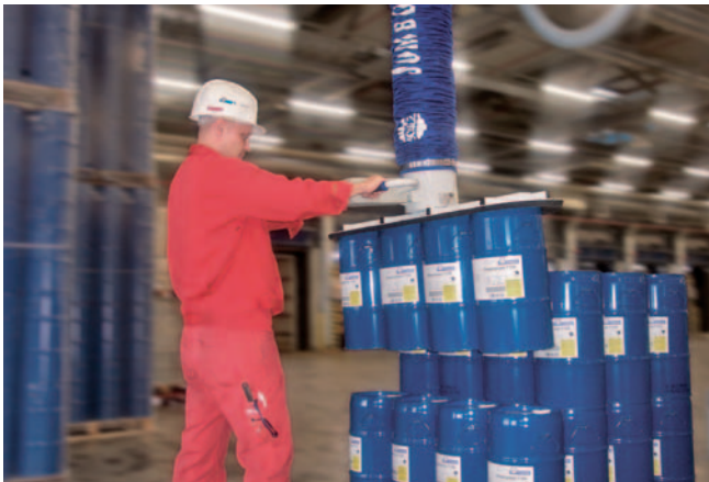
JumboErgo, Traglast 140 kg mit kundenspezifischer Sauggreiferlösung, zur gleichzeitigen Handhabung von vier Fässern
