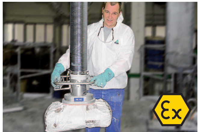
JumboSprint, Traglast 65 kg mit Sacksauggreifer, zur Handhabung von Säcken im Ex-Schutz-Bereich nach ATEX
