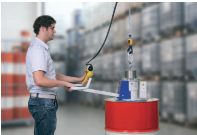
VacuMaster Eco, Traglast 250 kg, horizontal zur Handhabung von Fässern
