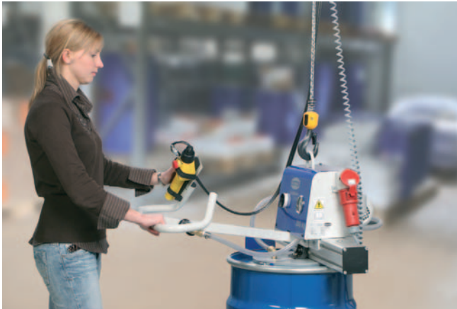
VacuMaster Basic, Traglast 250 kg, horizontal zur Handhabung von Fässern
