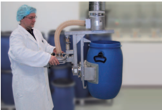
JumboErgo, Traglast 85 kg mit seitlichem Fasssauggreifer, zur Handhabung und Entleerung von Fässern
