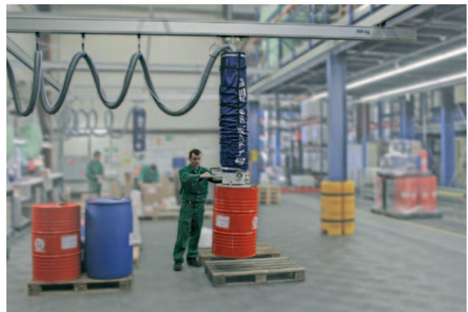
JumboErgo, Traglast 300 kg mit Rundsauggreifer, zur Fasshandhabung
