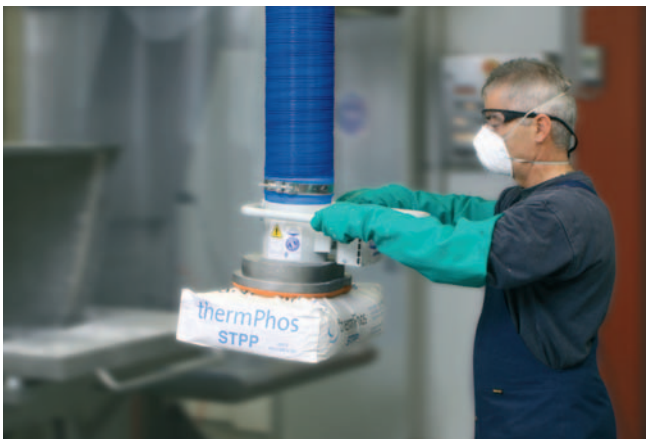
JumboSprint, Traglast 45 kg mit Sacksauggreifer, zur Handhabung von Kunststoff- und Papiersäcken
