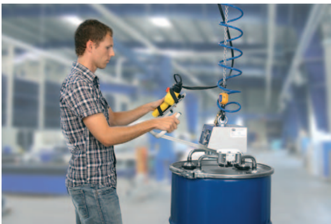
VacuMaster Eco, Traglast 250 kg, horizontal zur Handhabung von Fässern
