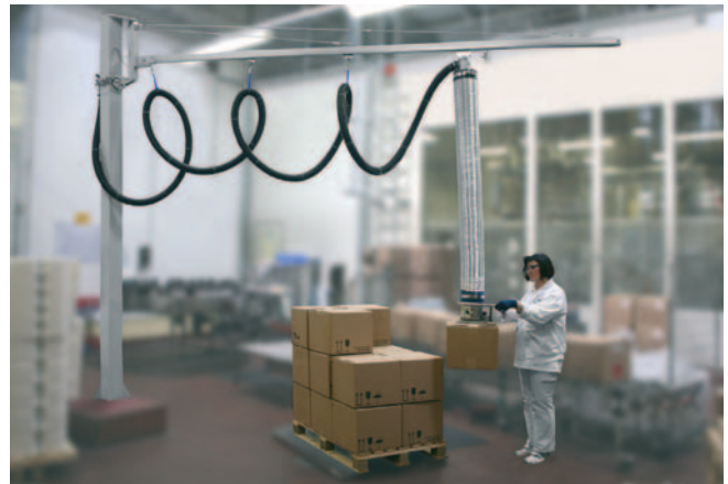
JumboSprint, Traglast 45 kg mit Einzelsauggreifer, zur Handhabung von Kartonagen im Ex-Schutz-Bereich nach ATEX
