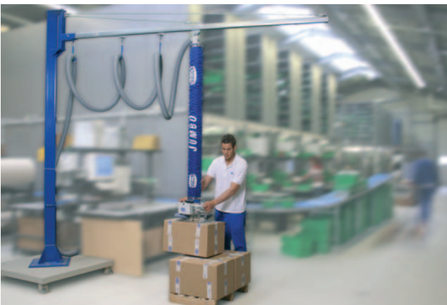
JumboSprint, Traglast 45 kg mit Doppelsauggreifer, zur Handhabung von Kartonagen
