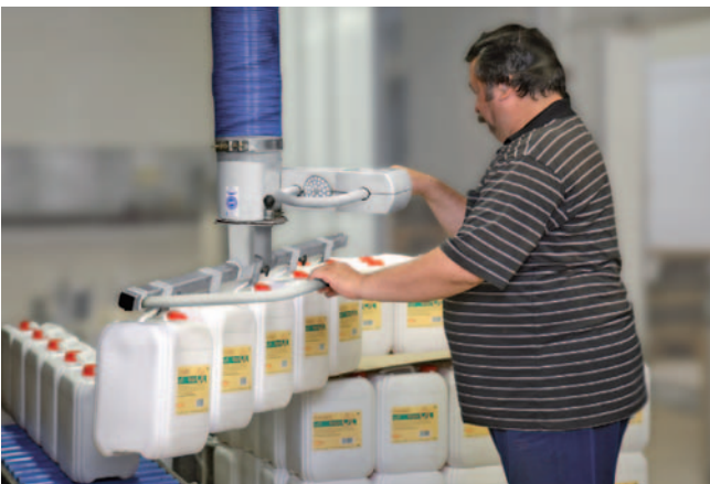
JumboErgo, Traglast 65 kg, zum Ab stapeln von fünf Kanistern am Rollenband
