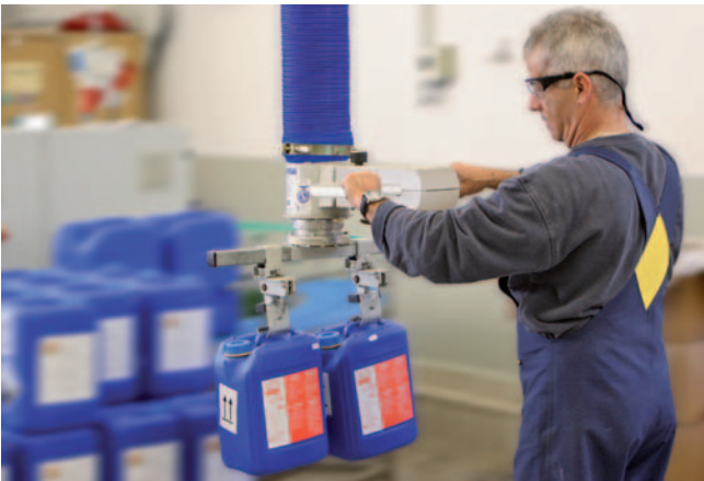
JumboErgo, Traglast 45 kg, zum Kommissionieren von Kanistern
