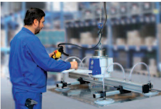
VacuMaster Eco, 250 kg Traglast, horizontal zur Handhabung von Blechen ohne Fremdenergie
