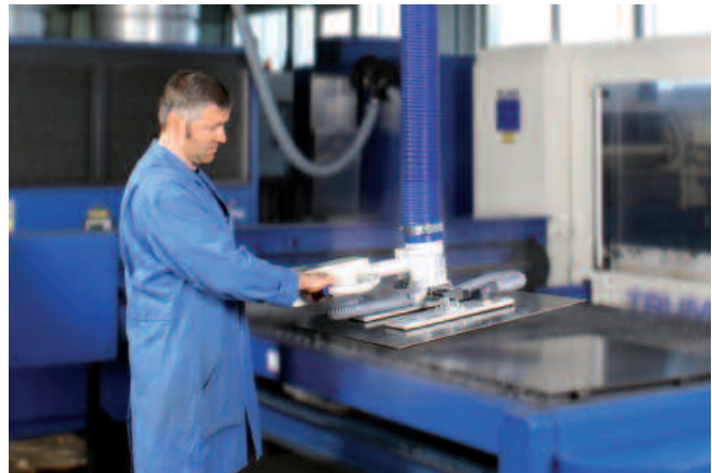
JumboErgo, 35 kg Traglast, mit Doppelsauggreifer FM zum sicheren Transport von Rohplatten sowie ausgeschnittener Stammbblätter (mehr S. 6)
