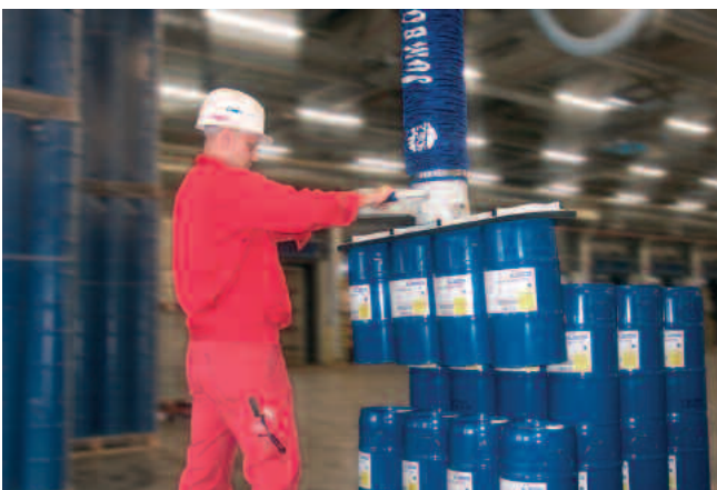
JumboErgo, 140 kg Traglast, mit kundenspezifischer Sauggreiferlösung zur gleichzeitigen Handhabung von 4 Fässern (mehr S. 6)
