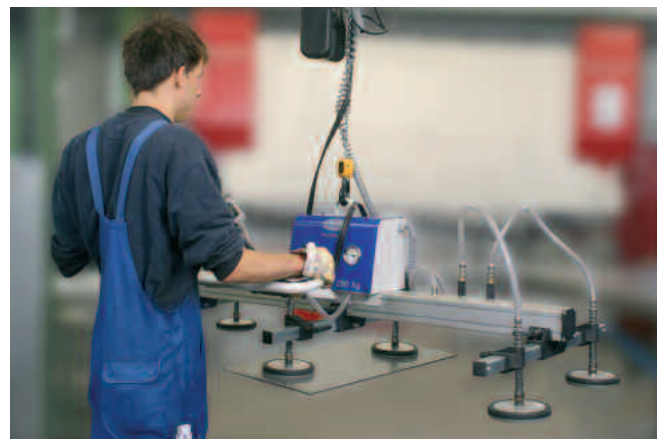
VacuMaster Basic, 250 kg Traglast, horizontal zur Handhabung von kleinen Plattenformaten oder Platten mit Ausschnitt durch einzeln abschaltbare Sauger (mehr S. 7)
