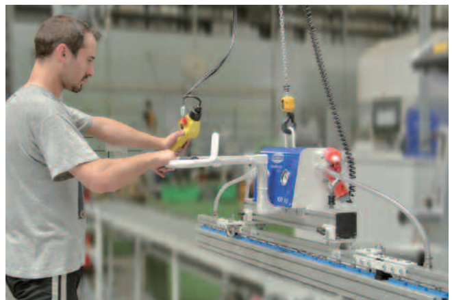
VacuMaster Basic, 100 kg Traglast, horizontal zur Handhabung von Aluminiumprofilen (mehr S. 7)
