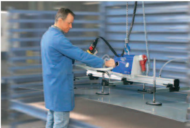
VacuMaster Basic, 250 kg Traglast, horizontal zur Be- und Entladung von Blechregalsystemen (mehr S. 7)
