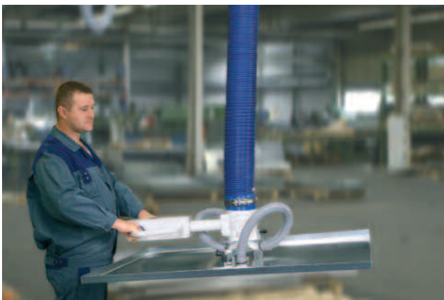
JumboErgo, 45 kg Traglast mit Doppelsauggreifer FM, zur Beladung von Beklebanlagen (mehr S. 6)
