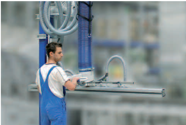
JumboErgo, 110 kg Traglast, horizontal zur Handhabung von Aluminiumprofilen (mehr S. 6)
