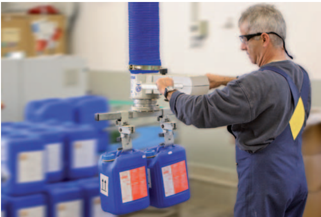
JumboErgo, capacidad de carga de 45 kg, para la preparación de expediciones de garrafas
