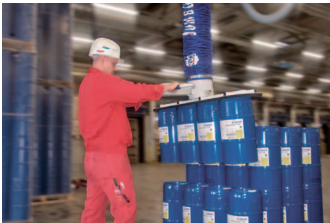
JumboErgo, capacidad de carga de 140 kg, con solución de ventosas específica del cliente para la manipulación simultánea de cuatro bidones
