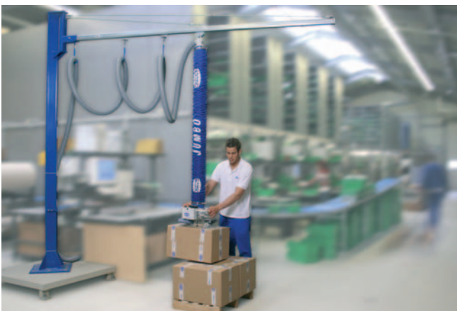
JumboSprint, capacidad de carga de 45 kg, con ventosa doble para la manipulación de cartones
