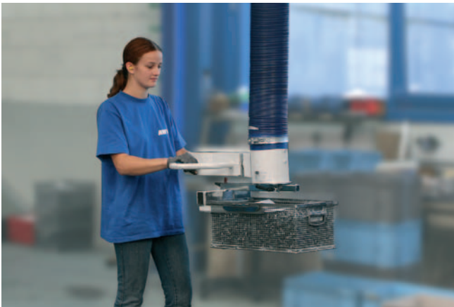
JumboErgo, capacidad de carga de 65 kg, con garras mecánicas para cajas para la manipulación de cajas de metal
