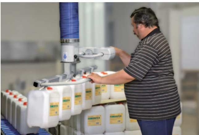
JumboErgo, capacidad de carga de 65 kg, para el apilado de cinco garrafas en la cinta de rodillos
