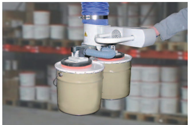
JumboErgo, capacidad de carga de 45 kg, con ventosas dobles para el transporte simultáneo de dos cubos
