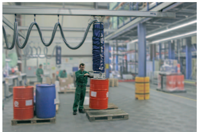
JumboErgo, capacidad de carga de 300 kg, con ventosa redonda para la manipulación de bidones
