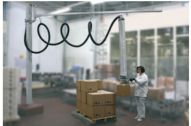
JumboSprint, capacidad de carga de 45 kg, con ventosas individuales para la manipulación de cartones en zonas con peligro de explosión según ATEX
