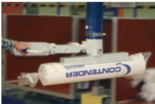
JumboErgo, charge de 45 kg, pour la préparation de rouleaux de textile emballés
