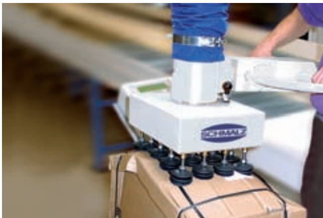
JumboErgo, charge de 45 kg avec ventouse multiple Compact pour la manipulation de produits instables en carton
