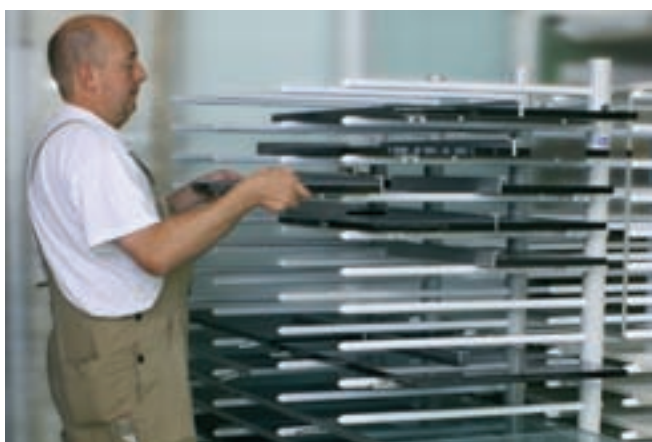
Chariot à fourches HW pour la dépose et le transport de pièces
