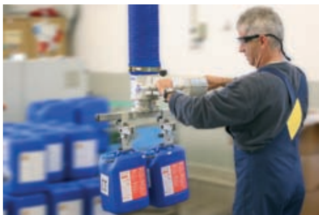
JumboErgo, charge de 45 kg pour le dépilage de bidons sur transporteur à rouleau
