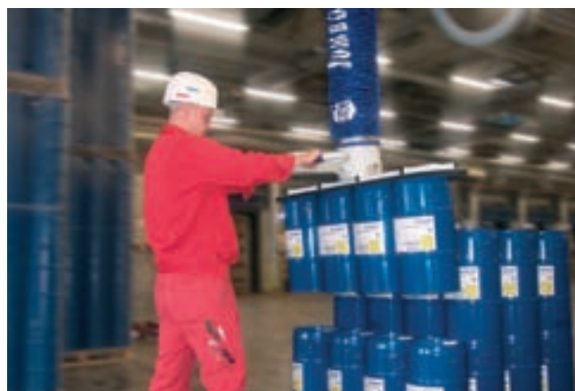
JumboErgo, charge de 140 kg pour la manipulation simultanée de 4 fûts
