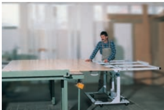
Chariot de transport de plaques PTS 250 pour l'enlèvement de panneaux à partir de magasins verticaux
