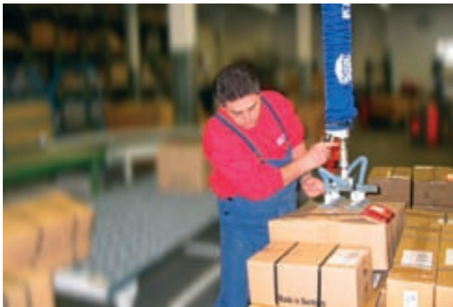
JumboHandy, charge de 30 kg avec ventouse double pour la manipulation de produits en carton
