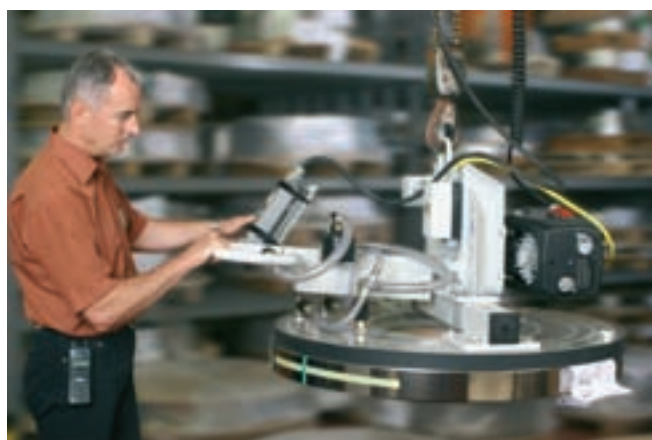
VacuMaster Coil, charge de 750 kg, horizontal, pour la manipulation de bobines inox
