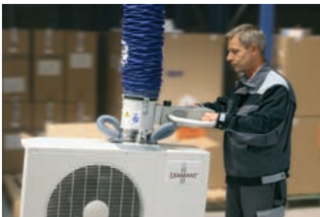
JumboErgo, charge de 85 kg avec ventouse double pour la manipulation de climatiseurs
