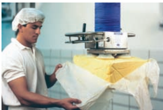
JumboSprint, charge de 65 kg, modèle en acier spécial, pour la manipulation de denrées alimentaires
