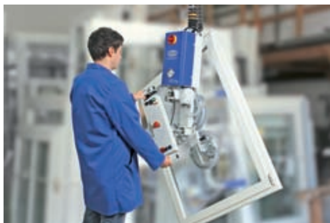
VacuMaster Window Comfort, charge de 170 kg, pour la manipulation verticale de fenêtres à plusieurs vantaux
