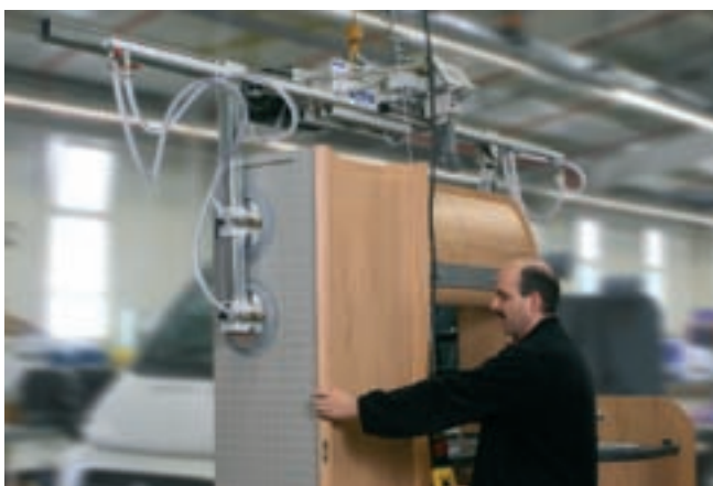
VacuMaster Box, charge de 200 kg, pour le montage d'éléments de cuisine dans la construction de caravanes
