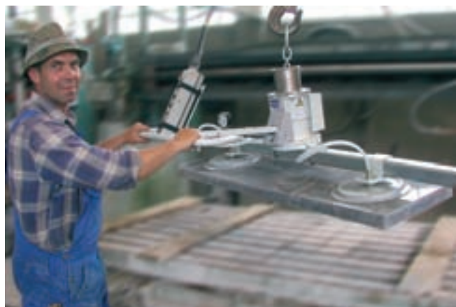
VacuMaster Eco, charge de 250 kg, chargement et déchargement horizontal de machines d'usinage de la pierre
