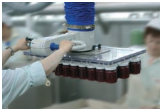
JumboErgo, charge de 85 kg pour la manipulation de 48 pots de confiture
