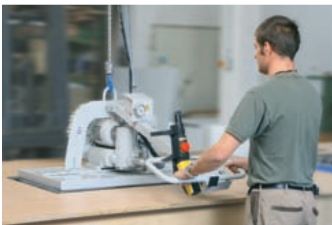
VacuMaster Multi, charge de 400 kg, chargement horizontal d'une machine de sciage de panneaux de grande dimension
