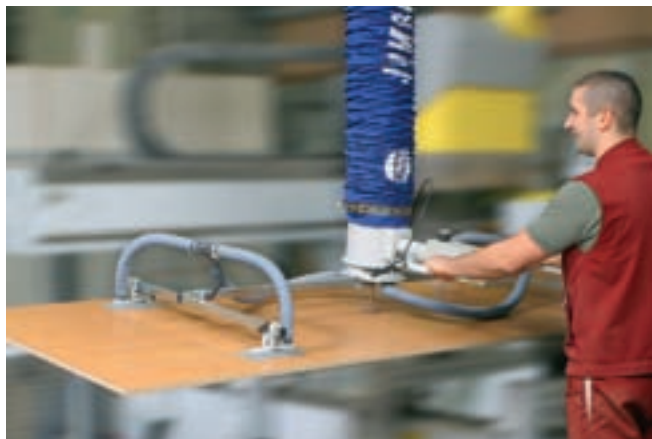
JumboErgo, charge de 85 kg avec ventouse multiple pour le chargement et déchargement de machines d'usinage CNC
