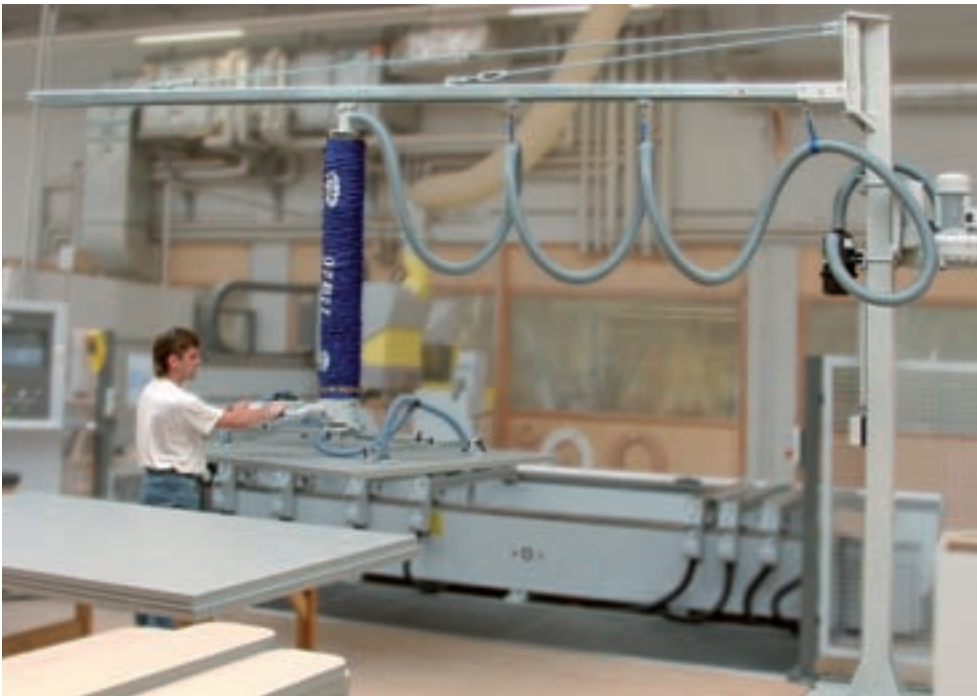
JumboErgo, charge de 85 kg avec ventouse quadruple pour le chargement et déchargement de machines d'usinage CNC pour le bois
