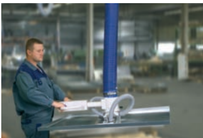
JumboErgo, charge de 45 kg avec ventouse double pour le chargement d'installations d'encollage
