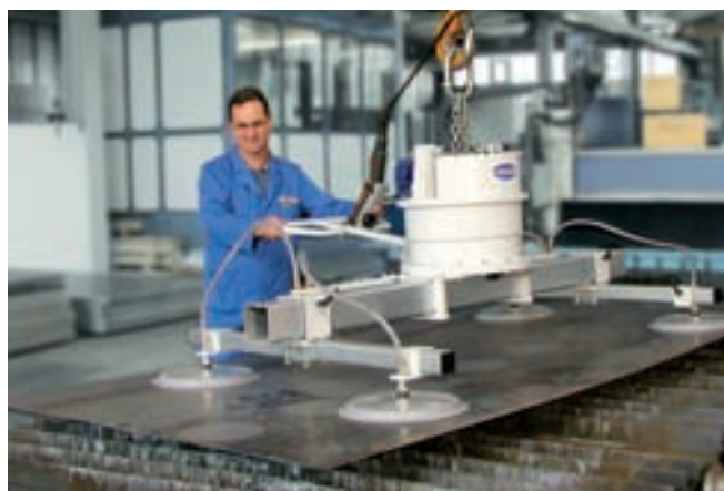
VacuMaster Eco, charge de 1000 kg, chargement et déchargement horizontal de machines de découpe au laser
