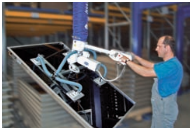
JumboErgo, charge de 70 kg, avec unité pivotante pneumatique pour la préhension horizontale de panneaux solaires et leur dépose verticale sur un chariot de service
