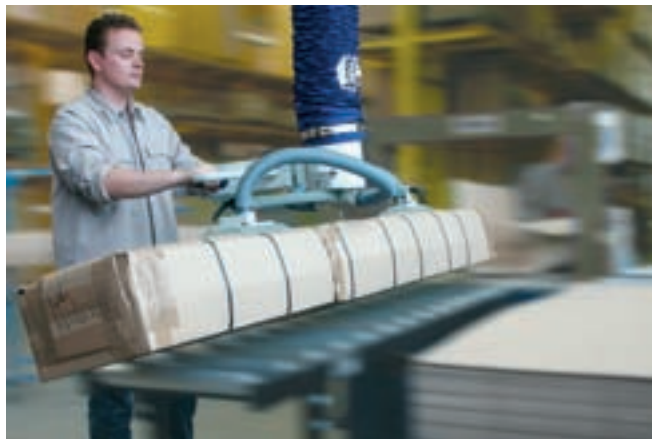
JumboErgo, charge de 85 kg avec ventouse double pour la manipulation de produits en carton pouvant atteindre 4 m
