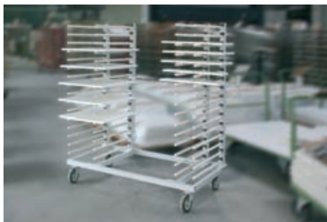
Chariots à fourches HWV pour la dépose et le transport de pièces
