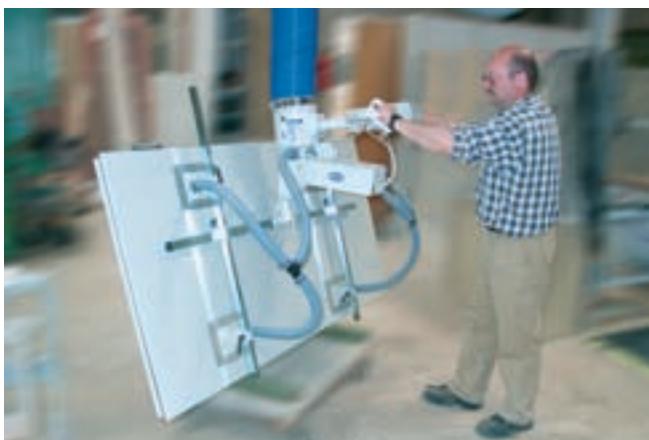
JumboErgo, charge de 90 kg avec unité pivotante pneumatique et ventouse quadruple pour la manipulation de panneaux de bois
