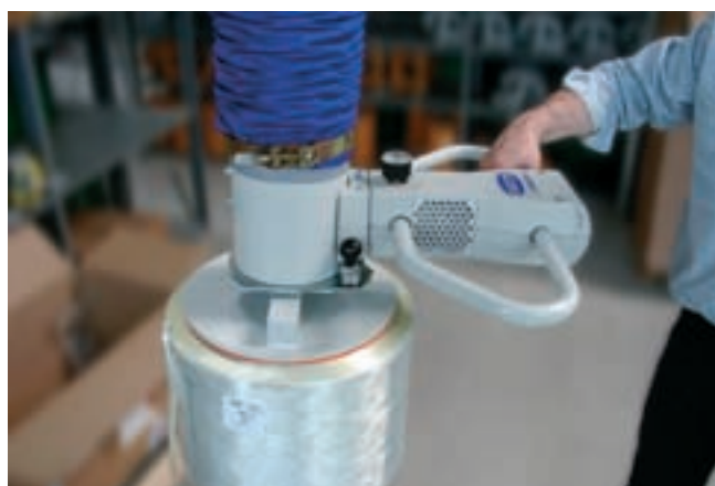
JumboErgo, charge de 65 kg avec ventouse ronde pour la manipulation de rouleaux de film
