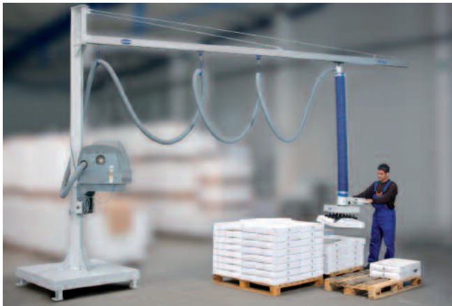
Potence sur colonne avec flèche en aluminium et embase, charge de 65 kg, longueur de flèche : 5 m
