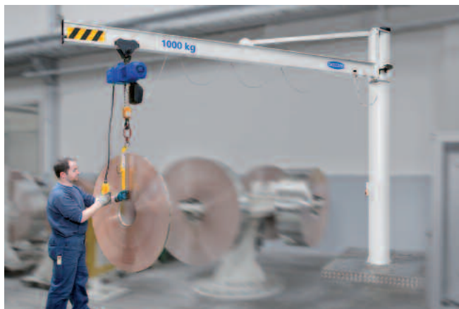
Potence sur colonne avec flèche en acier, charge de 1000 kg, longueur de flèche : 5 m
