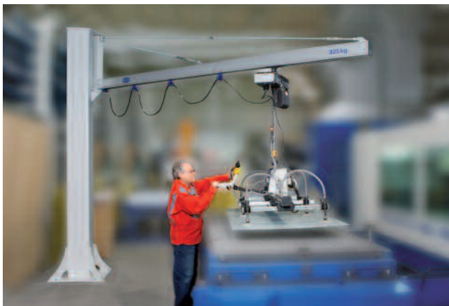
Potence sur colonne avec flèche en aluminium, charge de 325 kg, longueur de flèche : 4 m
