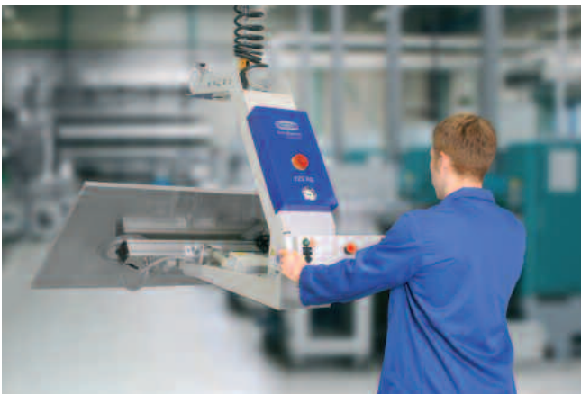
VacuMaster Comfort, charge de 125 kg, retournement à 180°, pour la manipulation de tôles (voir p. 7)
