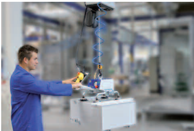
VacuMaster Light, charge de 100 kg, manipulation horizontale de produits étanches vernis
