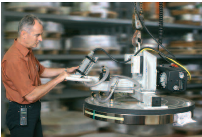
VacuMaster Coil, charge de 750 kg, manipulation horizontale de bobines de feuilard inox (voir p. 8)
