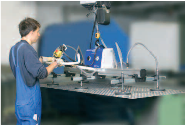
VacuMaster Basic, charge de 250 kg, manipulation horizontale de tôles ondulées (voir p. 7)
