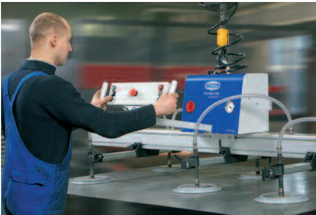
VacuMaster Comfort, charge de 750 kg, manipulation horizontale de plaques de tôle
