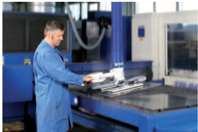
JumboErgo, charge de 35 kg avec ventouses doubles FM pour un transport en toute sécurité de dalles brutes et dalles sciées (voir p. 6)
