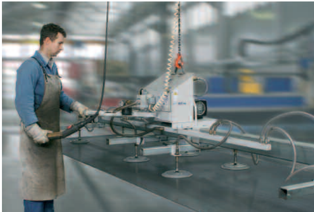
VacuMaster Vario, charge de 1000 kg, chargement et déchargement horizontal d'installations de découpe à plasma
