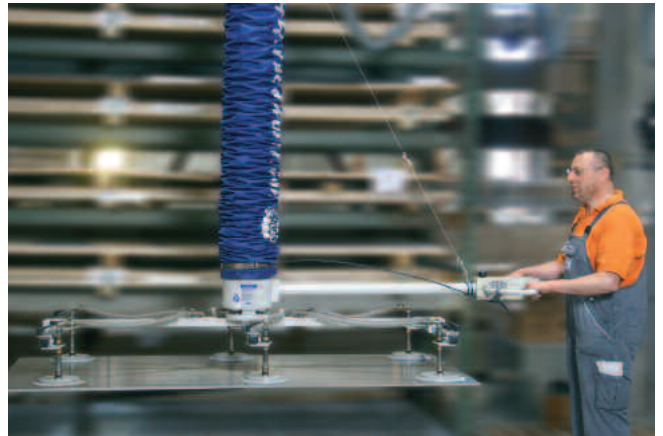
JumboErgo, charge de 140 kg, pour la préparation de tôles d'aluminium de moyens et petits formats (voir p. 6)
