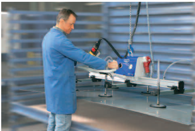
VacuMaster Basic, charge de 250 kg, chargement et déchargement horizontal de systèmes de rayonnage de tôles (voir p. 7)
