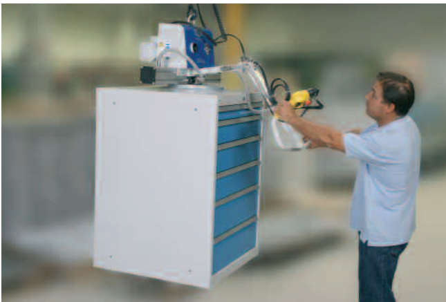
VacuMaster Basic, charge de 250 kg, manipulation horizontale d'armoires à tiroirs (voir p. 7)
