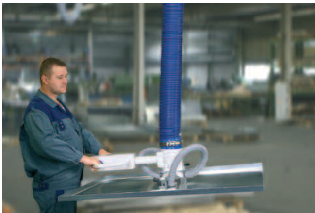
JumboErgo, charge de 45 kg avec ventouse double FM pour le chargement d'installations d'encollage (voir p. 6)
