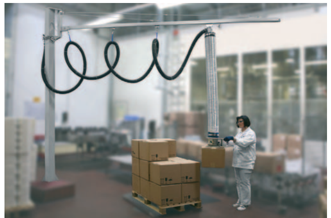
JumboSprint, charge de 45 kg avec ventouse individuelle pour la manipulation de produits en carton dans les environnements explosifs conformément à la directive ATEX
