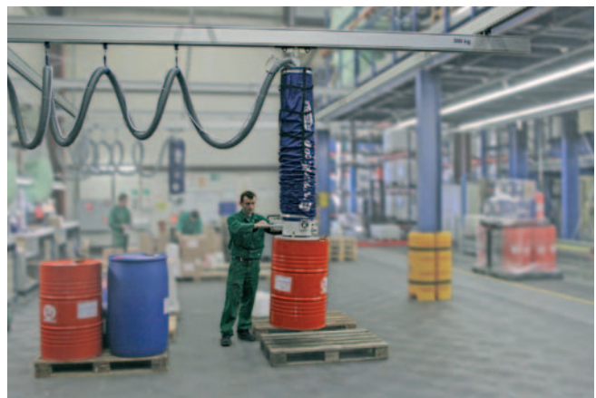
JumboErgo, charge de 300 kg à ventouse ronde pour la manipulation de fûts
