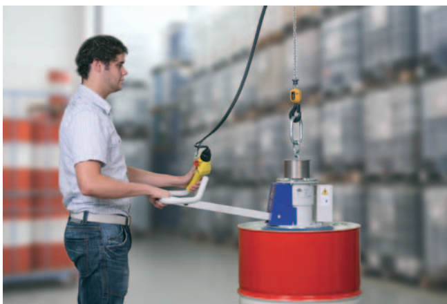
VacuMaster Eco, charge de 250 kg pour la manipulation horizontale de fûts
