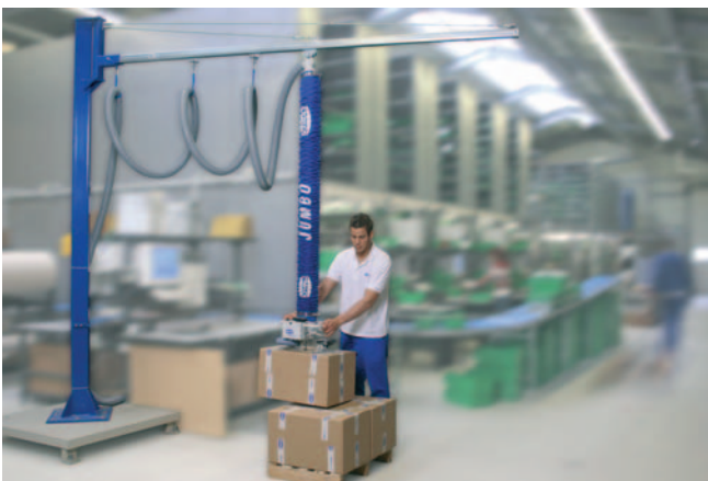
JumboSprint, charge de 45 kg avec ventouse double pour la manipulation cartons
