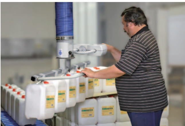
JumboErgo, charge de 65 kg pour le dépilage de cinq bidons sur transporteur à rouleau
