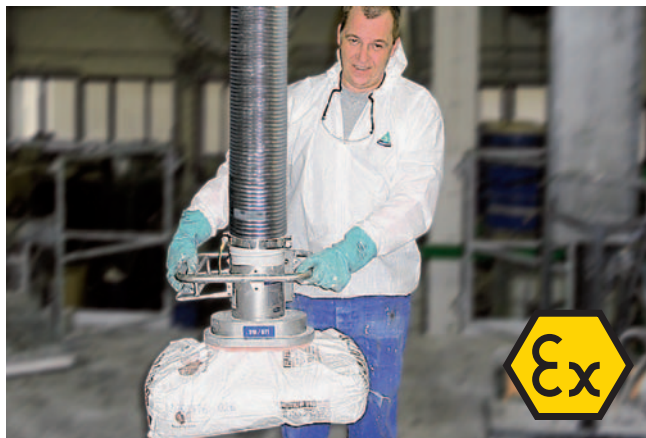
JumboSprint, charge de 45 kg avec ventouse pour sacs pour la manipulation de sacs dans les environnements explosifs conformément à la directive ATEX
