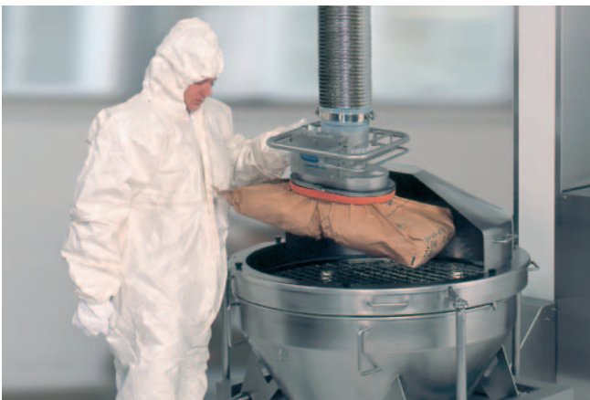
JumboSprint, charge de 65 kg avec ventouse pour sacs pour la manipulation de sacs dans les environnements explosifs conformément à la directive ATEX
