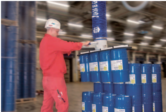
JumboErgo, charge de 140 kg avec solution de ventouses personnalisée pour la manipulation simultanée de 4 fûts
