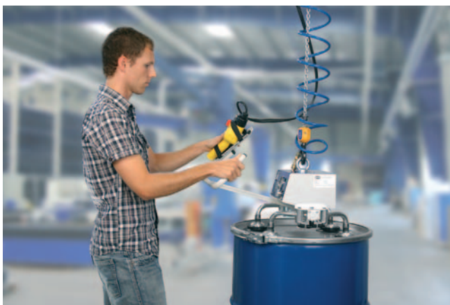
VacuMaster Light, charge de 100 kg pour la manipulation horizontale de fûts
