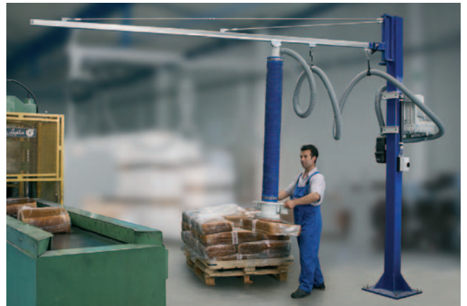
JumboSprint, charge de 65 kg avec ventouse pour sacs pour la manipulation de balles de caoutchouc brut
