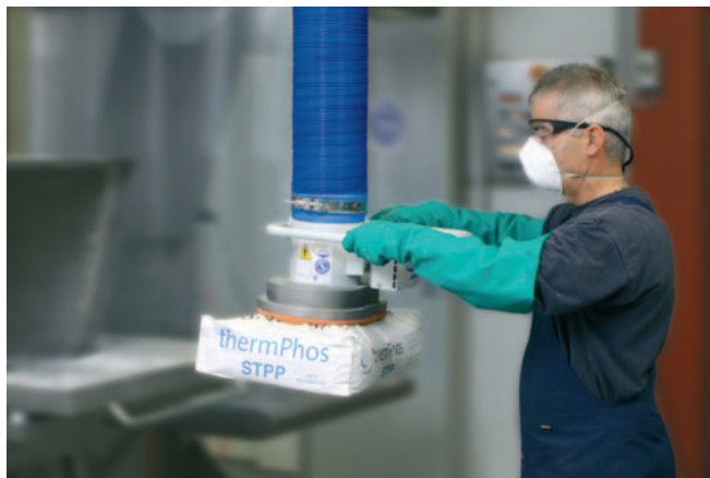
JumboSprint, charge de 65 kg avec ventouse pour sacs pour la manipulation de sacs de plastique et de papier
