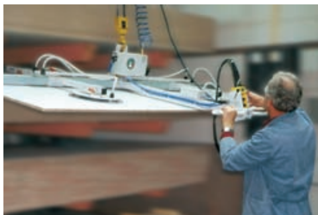
VacuMaster RE, carico 250 kg, orizzontale per il prelievo di pannelli di legno da scaffali a braccio spiovente e successivo carico di centri di lavorazione del legno CNC
