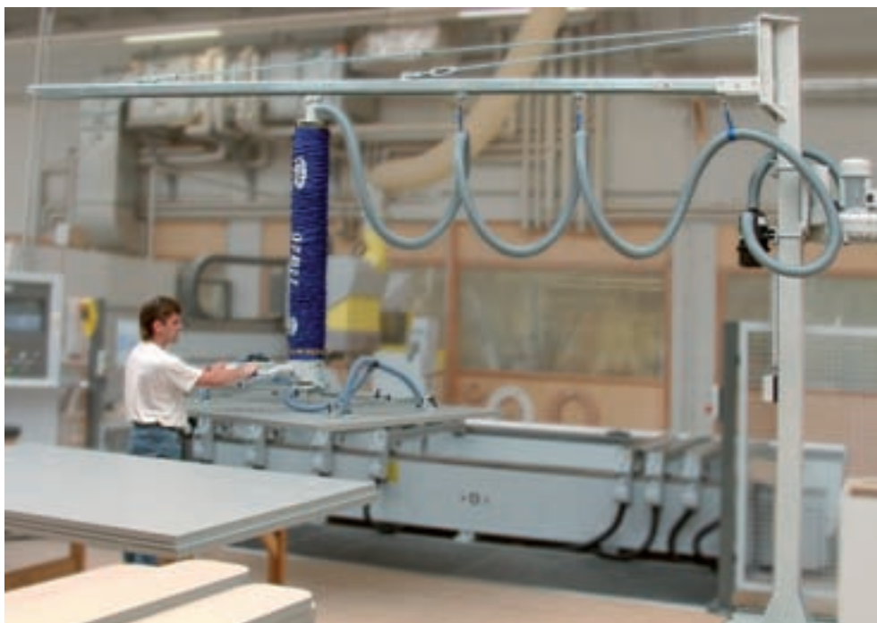
JumboErgo, carico 85 kg con ventosa quadrupla per il carico e lo scarico di centri CNC per la lavorazione del legno
