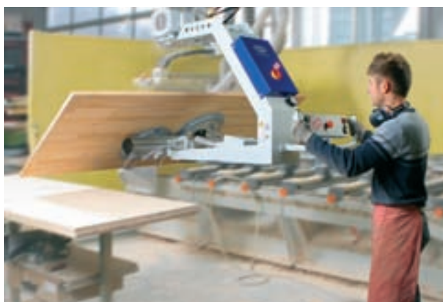
VacuMaster Comfort, carico 125 kg, inversione a 180° per il carico di macchine CNC con pannelli in legno lamellare
