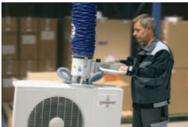
JumboErgo, carico 85 kg con ventosa doppia per la movimentazione di climatizzatori
