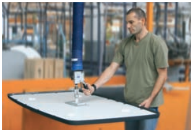
JumboHandy, carico 30 kg, con ventosa semplice per la composizione di tavoli da campeggio
