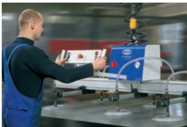
VacuMaster Comfort, carico 750 kg, orizzontale per la movimentazione di piastre in lamiera
