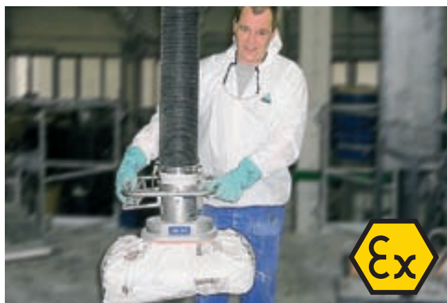
JumboSprint, carico 45 kg con ventosa per sacchi, per la manipolazione di sacchi in zona protetta Ex secondo ATEX
