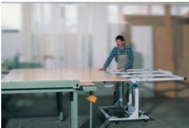
Carrello di trasporto pannelli PTS 250 per il carico di pannelli in pile verticali
