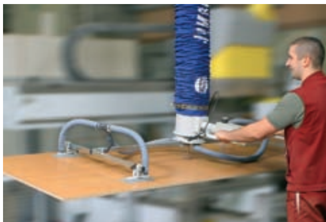
JumboErgo, carico 85 kg con ventosa quadrupla per il carico e lo scarico di macchine CNC per la lavorazione del legno
