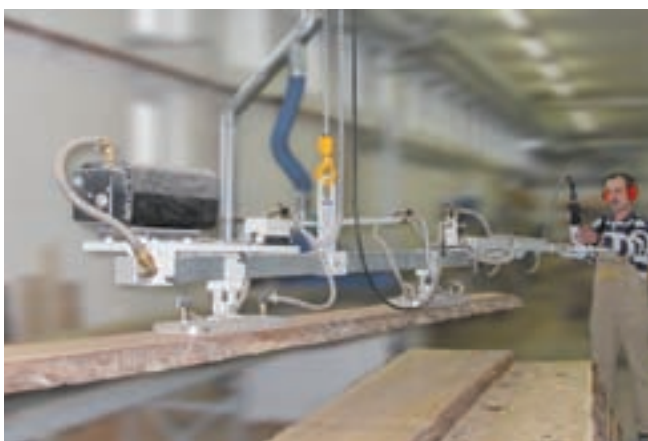
VacuMaster VHB, carico 500 kg, per la manipolazione di tavole ancora grezze dopo essere state segate
