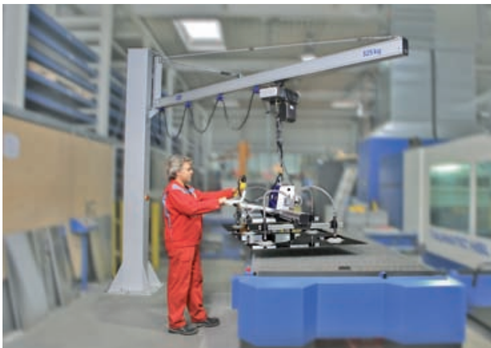
VacuMaster Basic, carico 250 kg, orizzontale per la movimentazione di lamiere in acciaio inox
