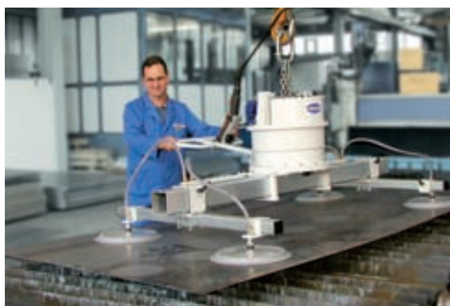
VacuMaster Eco, carico 1000 kg, orizzontale per il carico e lo scarico di macchine per taglio al laser
