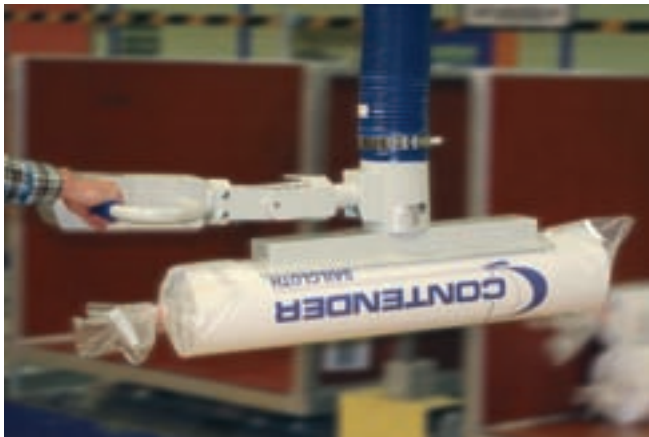
JumboErgo, carico 45 kg, per la composizione di rulli di stoffa imballati in pellicola
