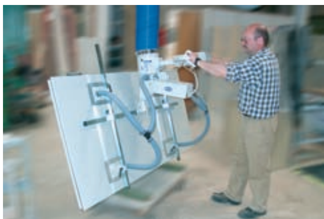
JumboErgo, carico 90 kg con unità di rotazione pneumatica e ventosa quadrupla, per la manipolazione di pannelli in legno
