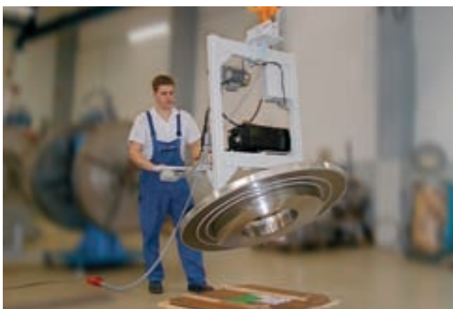
VacuMaster Coil, carico 750 kg, ruotabile a 90°, per la movimentazione di anelli di nastro cesoiato e bobine
