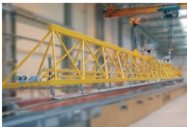
VacuMaster Roto, carico 1.500 kg, per la movimentazione di pale in semi-gusci
