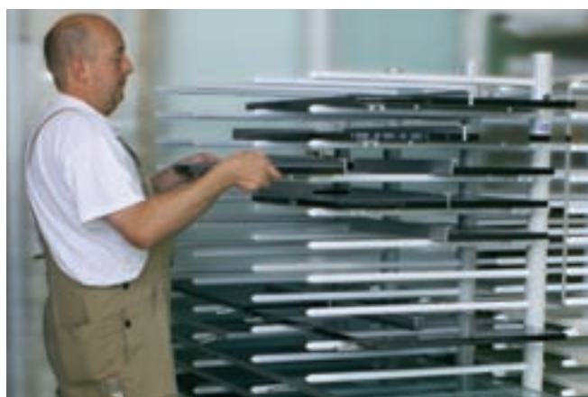
Carrello di trasporto HW per il deposito e il trasporto di pezzi
