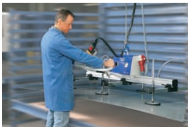
VacuMaster Basic, carico 250 kg, orizzontale per il carico e lo scarico di sistemi di scaffali in lamiera
