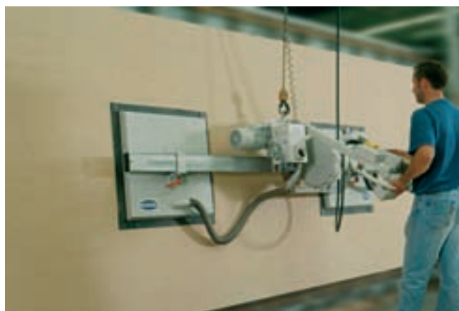
VacuMaster Multi, carico 300 kg, verticale per il carico di seghe verticali
