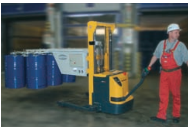
VacuMaster, carico 140 kg, per il trasporto di fusti dal luogo di scarico dei camion al nastro trasportatore
