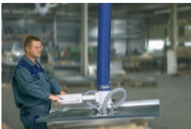
JumboErgo, carico 45 kg con ventosa doppia per il carico di impianti di incollaggio
