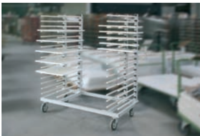
Carrello di trasporto HWV per il deposito e il trasporto di pezzi
