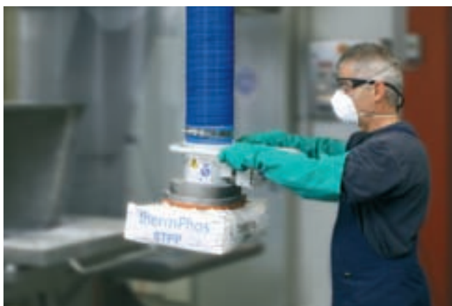
JumboSprint, carico 65 kg con ventosa per sacchi, per la manipolazione di sacchi di plastica e di carta
