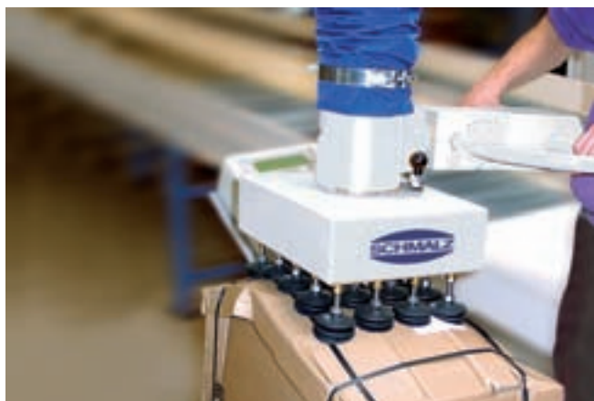
JumboErgo, carico 45 kg con ventosa multipla Compact, per la manipolazione di cartoni instabili
