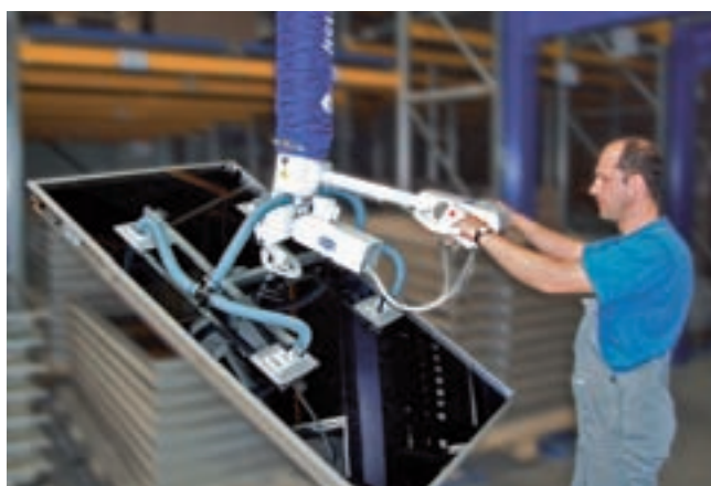
JumboErgo, carico 70 kg con unità di rotazione pneumatica, per la presa orizzontale di moduli solari e il successivo deposito verticale su un carrello commissionatore
