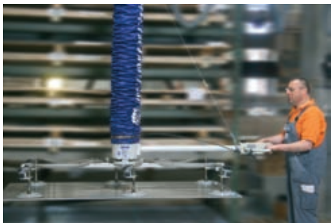
JumboErgo, carico 140 kg, per la composizione di lamiere in alluminio di formato medio-piccolo
