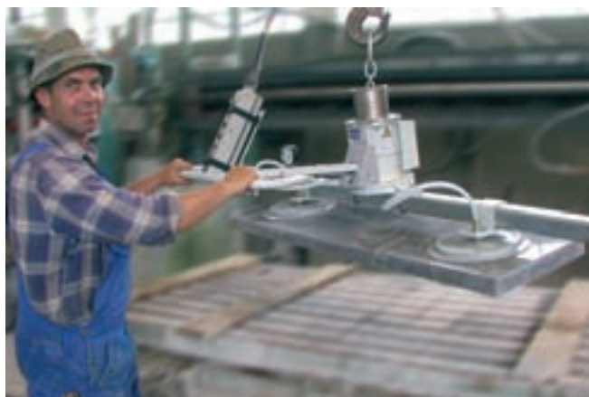
VacuMaster Eco, carico 250 kg, orizzontale per il carico e lo scarico di macchine per la lavorazione della pietra
