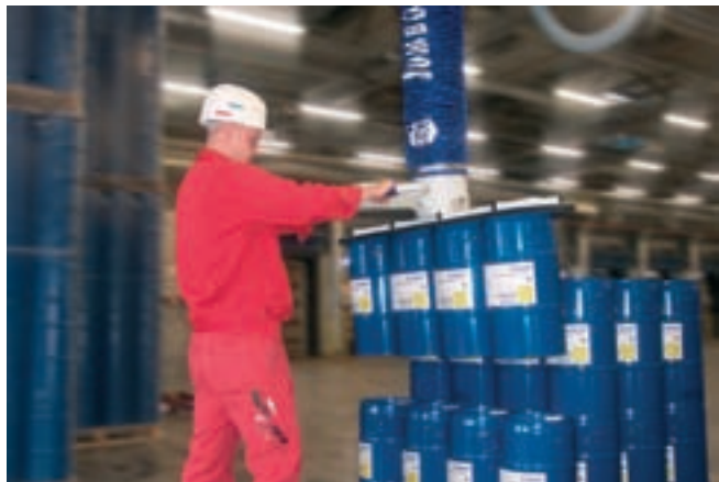
JumboErgo, carico 140 kg, per la movimentazione contemporanea di 4 fusti
