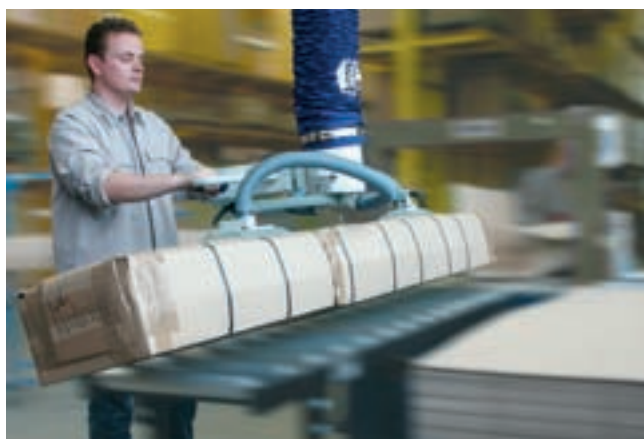
JumboErgo, carico 85 kg con ventosa doppia, per la manipolazione di cartoni lunghi fino a 4 m
