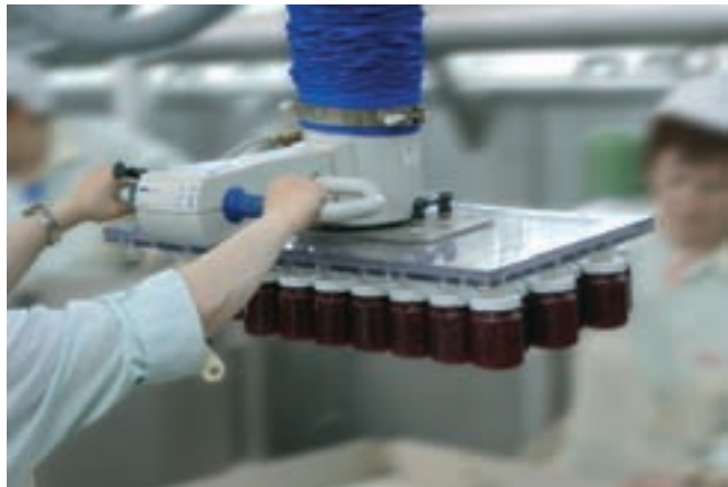
JumboErgo, carico 85 kg per la movimentazione di 48 vasetti di confettura
