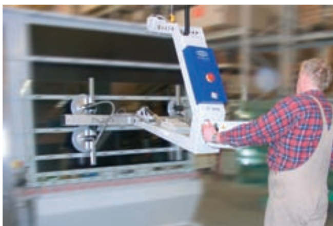
VacuMaster Comfort, carico 125 kg, capovolgimento di 180° per la movimentazione di lastre di vetro
