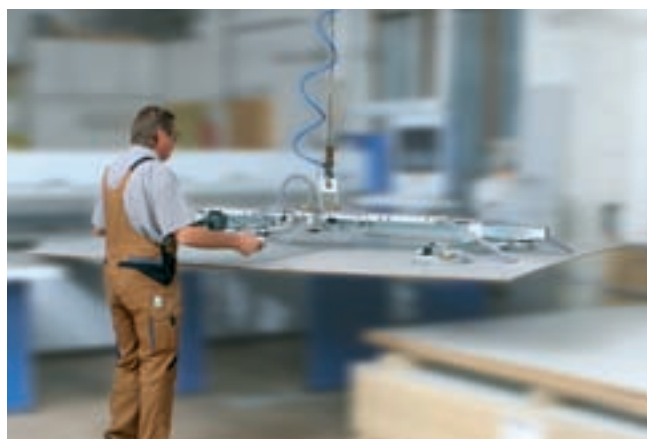
VacuMaster RE carico 250 kg, per il carico di macchine di lavorazione
