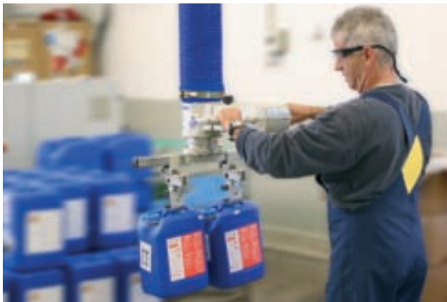
JumboErgo, carico 45 kg per l'impilaggio di taniche sul nastro scorrevole
