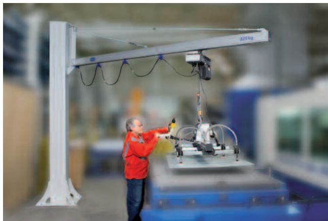
Gru girevole a colonna con rotaie in alluminio, carico 325 kg, lunghezza braccio 4 m
