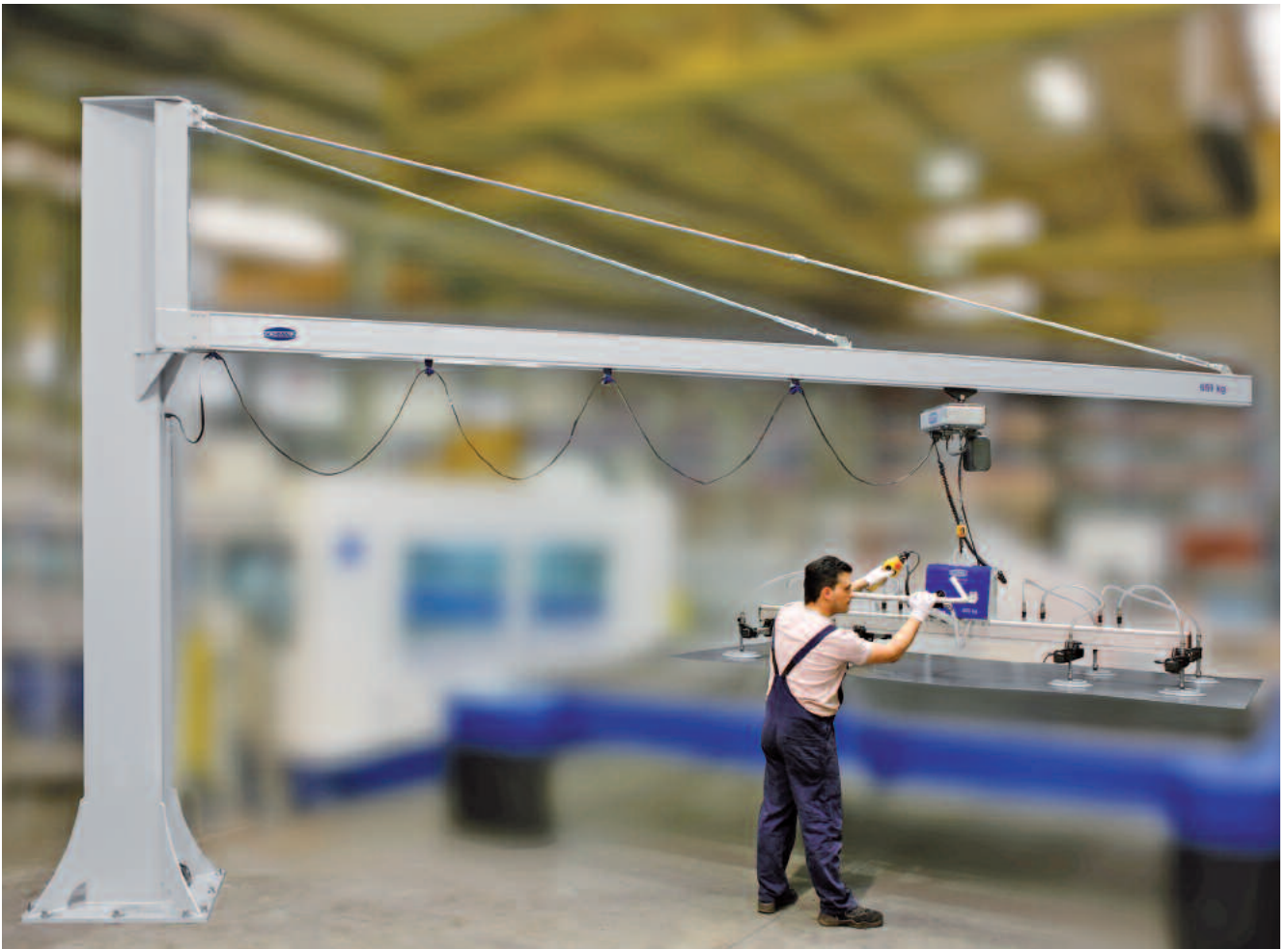
Gru girevole a colonna con rotaie in alluminio, carico 650 kg, lunghezza braccio 6 m
