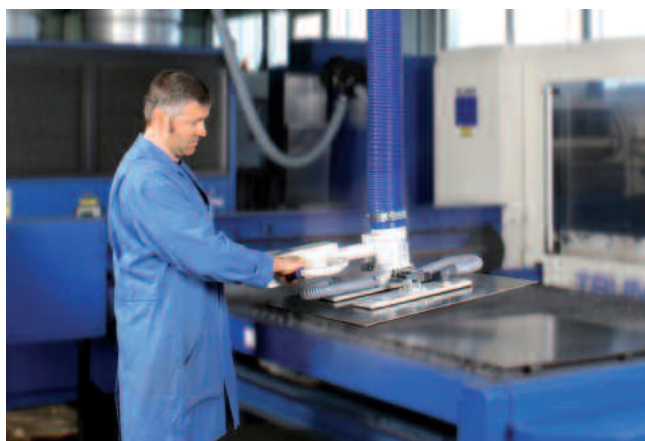
JumboErgo, carico 35 kg con ventosa doppia FM per il trasporto sicuro di lastre grezze e lame intagliate (di più a pag. 6)
