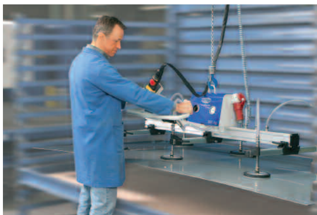
VacuMaster Basic, carico 250 kg, orizzontale per il carico e lo scarico di sistemi di scaffali in lamiera (di più a pag. 7)
