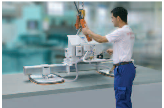
VacuMaster Vario, carico 2.000 kg, orizzontale per il carico di seghe con grandi lastre di alluminio (di più a pag. 8)
