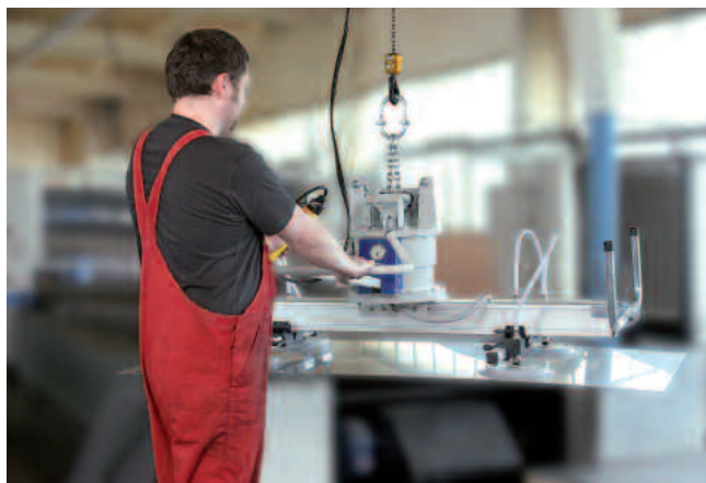
VacuMaster Eco, carico 500 kg con piedini di sostegno, per il carico di impianti di taglio laser (di più a pag. 7)
