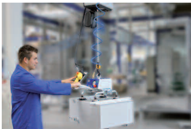
VacuMaster Light, carico 100 kg, orizzontale per la movimentazione di cassettiere verniciate
