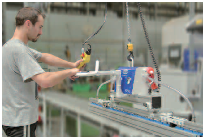
VacuMaster Basic, carico 100 kg, orizzontale per la movimentazione di profili in alluminio (di più a pag. 7)
