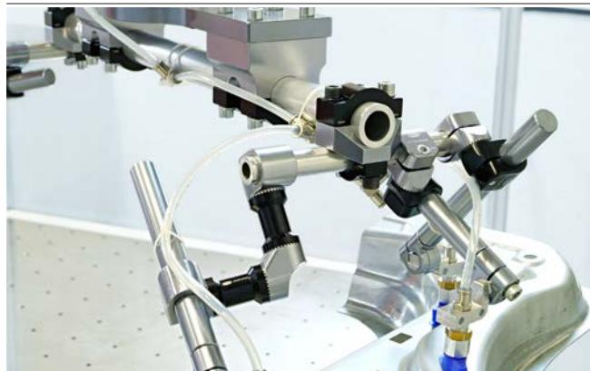
La brida del robot con fijación cuando se utiliza para manipular una pieza de chapa formada
