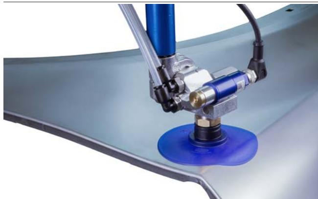
Soporte para ventosa HT-SG I con vacuestato VSi y ventosa tipo campana SAX durante la manipulación de una pieza de chapa
