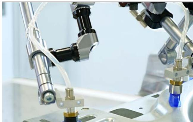
Conejor de raíl (dentado) SXT-TC en combinación con el soporte HT-SG y la ventosa SAX cuando se manipula una pieza de automóvil
