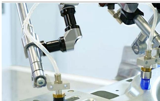
Conexión (engranada) SXT-CON-GB cuando se manipula una pieza de chapa formada
