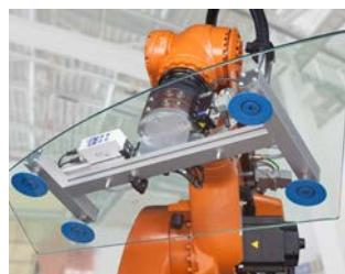
Manipulación de componentes en el montaje final de vehículos
