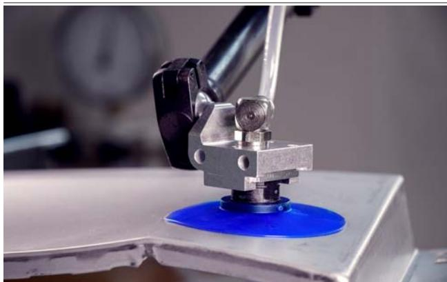
Soporte para ventosa HT-SG en combinación con ventosa tipo campana SAX durante la manipulación de una pieza de chapa
