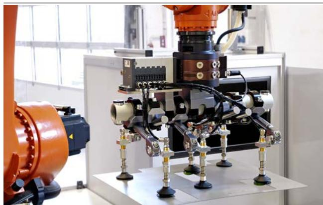
Piezas de fijación SXT-CL para la construcción de un Tooling completo para la manipulación de piezas de chapa moldeadas
