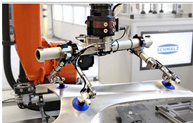
Tubo SXT-RT para la construcción de un Tooling completo para la manipulación de piezas de carrocería moldeadas
