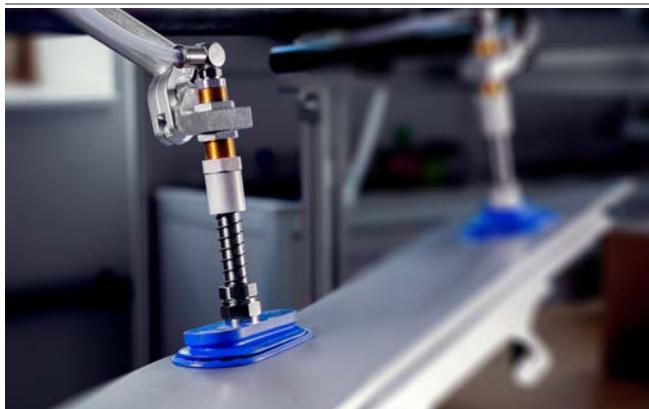
Soporte para biela elástica HT-FST en combinación con biela elástica FSTE-HDB durante la manipulación de una pieza de chapa
